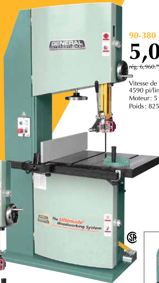
Système de guides de lame supérieur et inférieur de luxe à double bloc en bakélite. (90-290 et 90-380)
