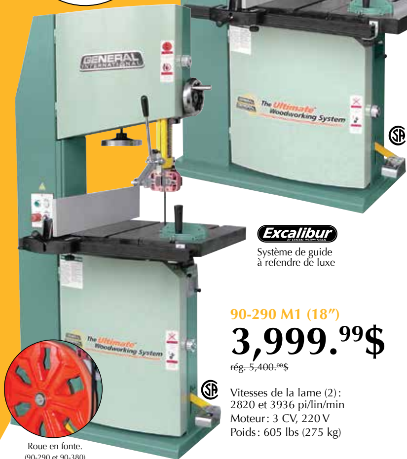
Système de guides de lame supérieur et inférieur de luxe à double bloc en bakélite. (90-290 et 90-380)
