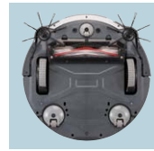
La brosse principale et les deux brosses latérales se combinent pour fournir un large chemin de nettoyage de plus de 18 po
