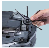
Les brosses latérales sont conçues pour aider à capturer les débris le long des murs, des coins et des obstacles
